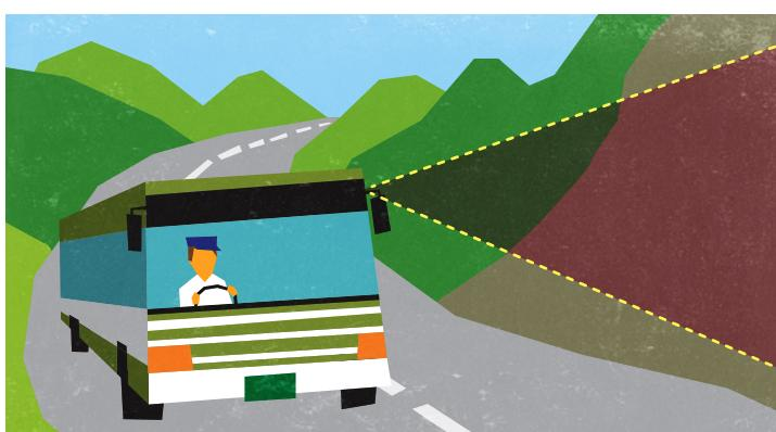
いまITの領域では「画像セグメンテーション」と呼ばれる技術が発達している。これはAIを用いて画像に映るモノの認識・分類を行うというもので、たとえば映像から空、路面、歩道、法面を抜き出してデータを蓄積していく。それを連日比較することで、昨日と今日のデータで変化があればアラートを出す仕組みにする。変化というのは法面に入ったクラック(ヒビ)、路上に落ちている落石、土砂の堆積といったもので、そうした変化の予兆を早めに察知することで、大きな崩落も早めに予測できるのではないか——というのが計画の概要であった。
