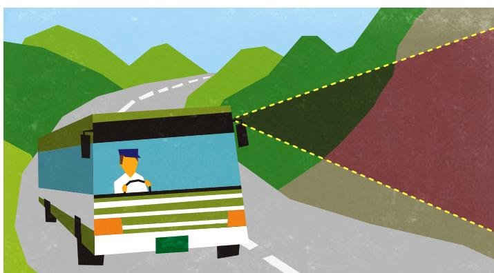
いまIoTの領域では「画像セグメンテーション」と呼ばれる技術が発達している。これはAIを用いて画像に映るモノの認識・分類を行うというもので、たとえば映像から空、路面、歩道、法面を抜き出してデータを蓄積していく。それを連日比較することで、昨日と今日のデータで変化があればアラートを出す仕組みにする。変化というのは法面に入ったクラック(ヒビ)、路上に落ちている落石、土砂の堆積といったもので、そうした変化の予兆を早めに察知することで、大きな崩落も早めに予測できるのではないか——というのが計画の概要であった。
